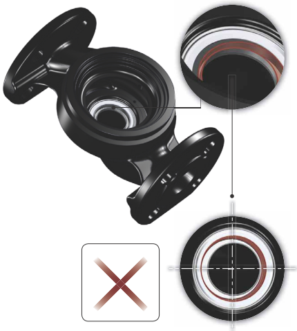
12. ábra Nem megfelelően középre igazított tömítések
