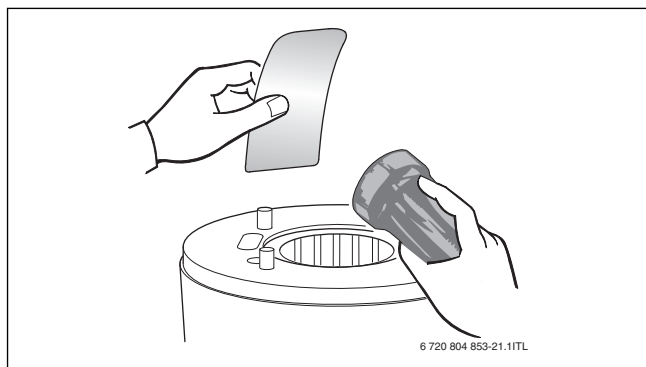
50. ábra A hőcserélő blokk szennyezettségének ellenőrzése
